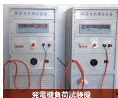
発電機負荷試験機
